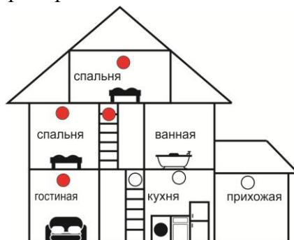
● Сигнализаторы дыма для обеспечения минимальной защиты
