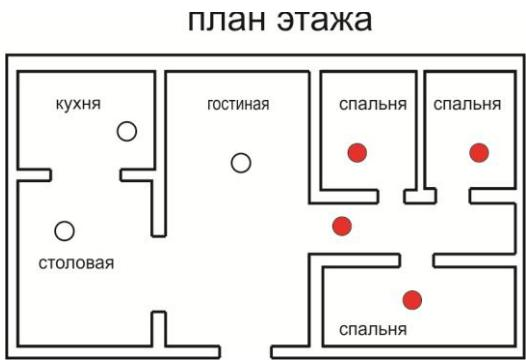
Рис.6 Пример установки сигнализаторов
