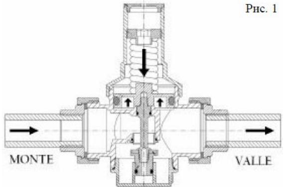
При открытии крана, вентиль (1) перемещается, вниз открывая проход воде. Это происходит из-за силы давления пружины на диафрагму (2) которая в данных условиях становится превалирующей в сравнении с силой воды. При увеличении расхода воды, увеличивается проток воды внутри редуктора из-за уменьшения давления, которому обычно подвергнут вентиль (1). При открытии нескольких кранов происходит падение давления ( $\Delta p$ ) на выходе, и последующее увеличение расхода (Q) как показано на рис. 2.
